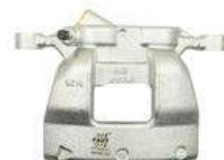
FT32831 BRZDOVÝ TŘMEN PŘEDNÍ PR 2.0 / 2.2 TDCI 1783931 / BK21-2B294-BA
